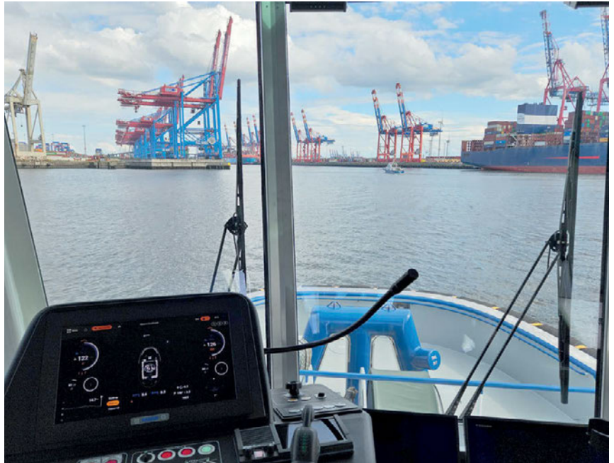
Die „Fairplay 96“ wurde bei Damen in den Niederlanden gebaut und im Dezember 2023 abgeliefert. Der Schlepper ist 24,73 m lang, 13,13 m breit und verfügt über einen Pfahlzug von 80,5 t.
