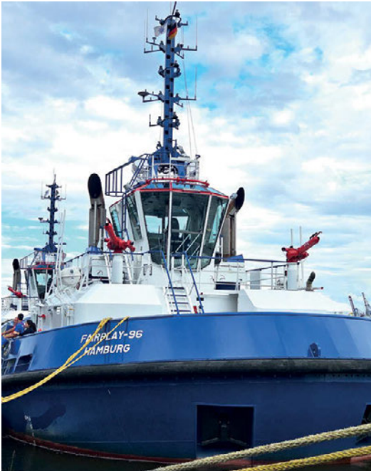
Die „Fairplay 96“ wurde bei Damen in den Niederlanden gebaut und im Dezember 2023 abgeliefert. Der Schlepper ist 24,73 m lang, 13,13 m breit und verfügt über einen Pfahlzug von 80,5 t.
