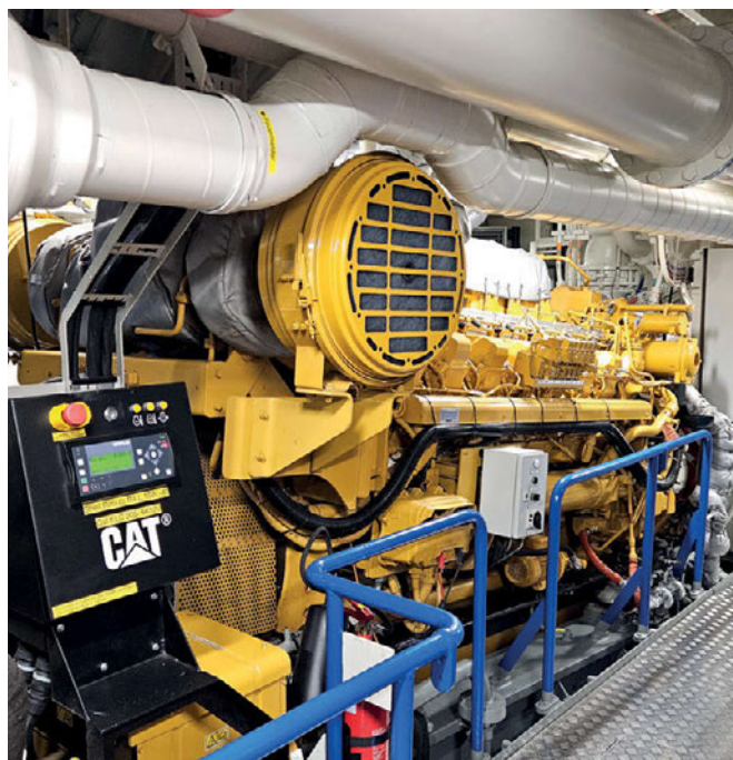
Zwei Caterpillar 3516 TA HD / D Hauptmotoren treiben den Schlepper an; die totale Leistung beträgt 5050 kW bei einer Drehzahl von 1800 min -1
