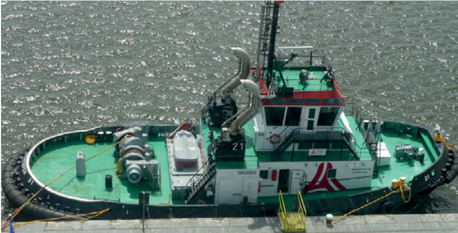
Der erste Methanol-betriebene Schlepper des Port of Antwerp
