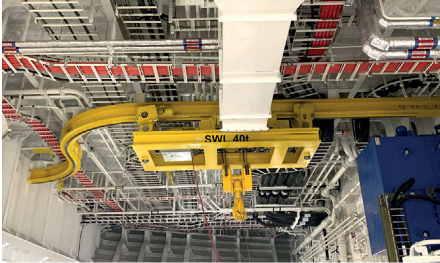
Fuchs Fördertechnik wird in Hamburg u.a. die Einschienen-Laufkatze SWL 40t mit Drehgestell-Fahrwerk, geeignet für den Einsatz auf Kurvenbahnen, vorstellen Foto: Fuchs Fördertechnik
