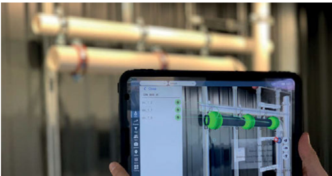
Digitale Werkerunterstützung zur Montage von Rohrhaltern Foto: Sikla
