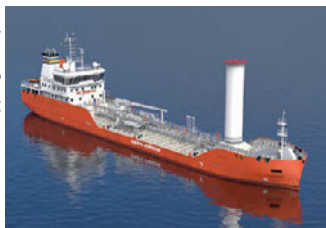
Visualisierung eines der bestellten Tanker mit Flettnerrotor
