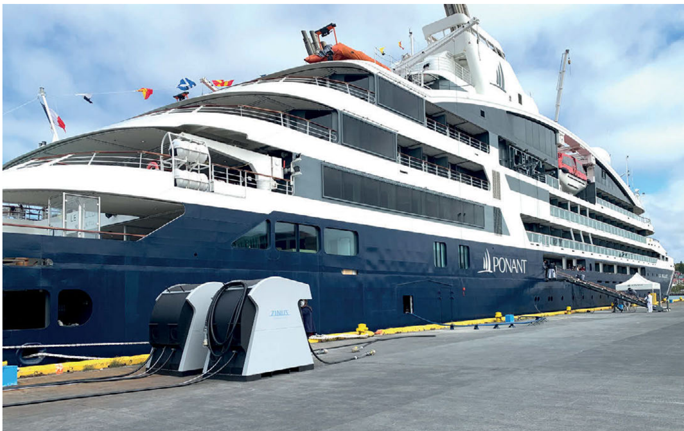
Das Zinus Port Power System ermöglicht eine flexible Landstromversorgung
