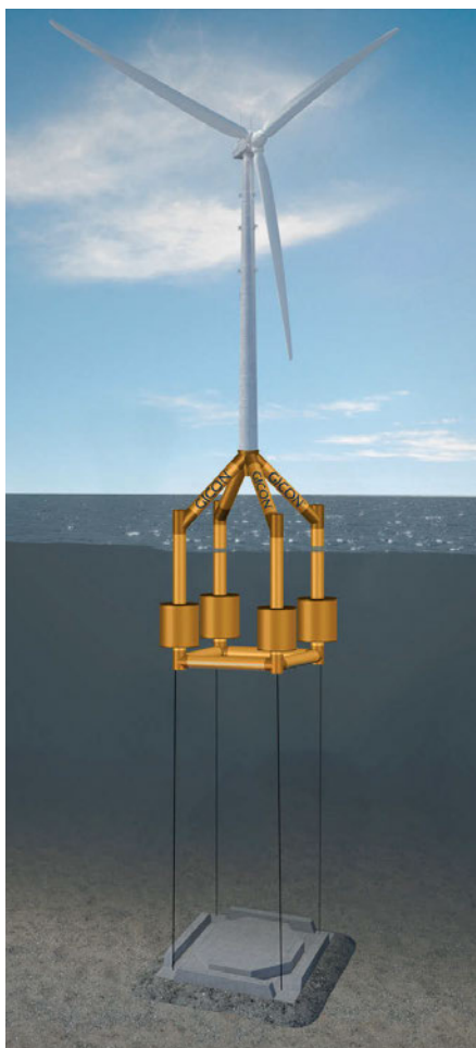
Abb. 1: Rendering von GICON's schwimmenden Offshore-Fundament
