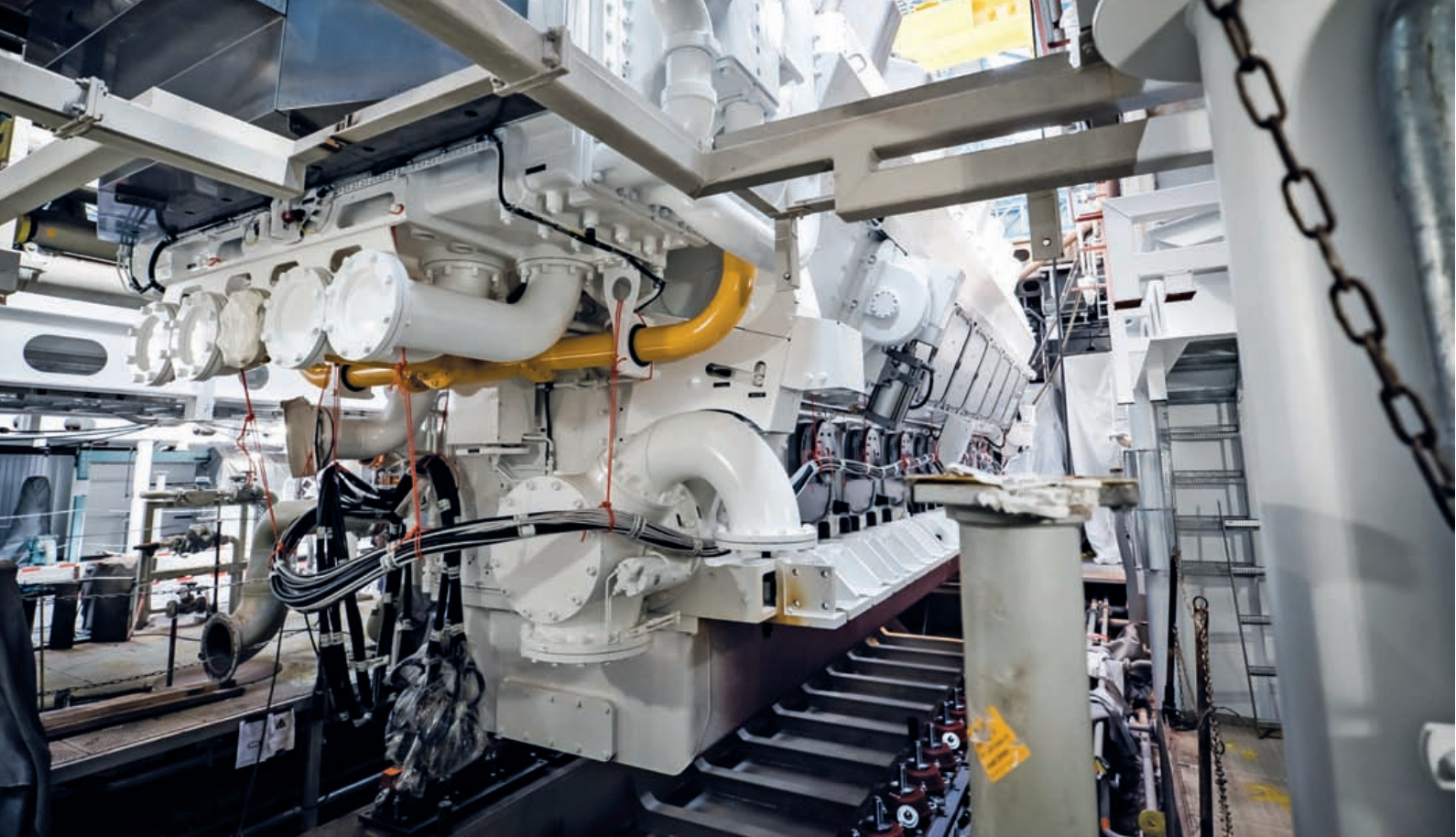
Vier Caterpillar MaK Dual Fuel-Motoren der Baureihe M46 DF sind auf der „AIDAnova“, dem ersten Kreuzfahrtschiff mit einem reinen LNG-Antrieb, installiert Foto: Felix Gaensicke/AIDA Cruises
